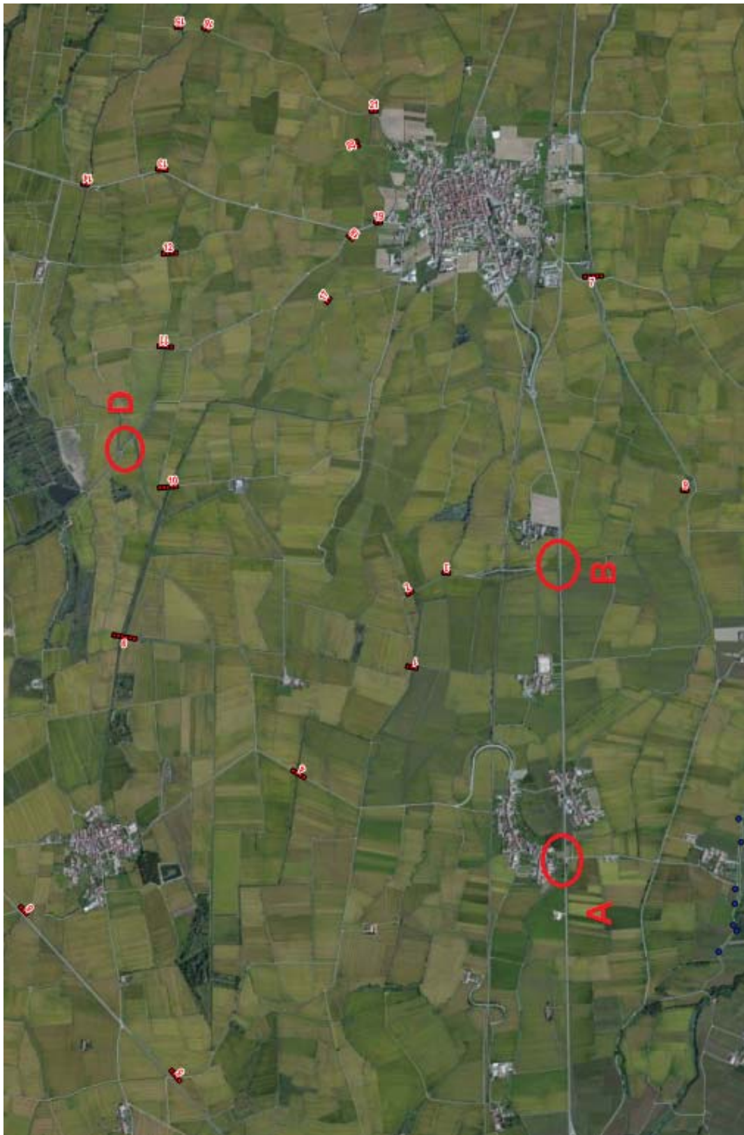
Figura 8 - Stralcio planimetrico del modello idrodinamico generale nell'intorno dell'abitato di Fontanetto Po con rappresentazione delle sezioni di rilievo e delle aree critiche.
